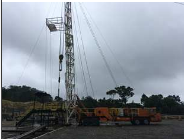
Figura 11 -- Sonda no MBW 43 para monitoramento por sonar.
